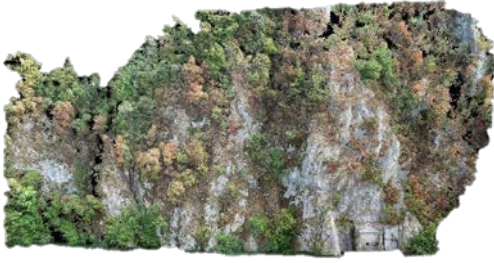
Oblak tačaka sa teksturom dobijen fotogrametrijskim postupkom
